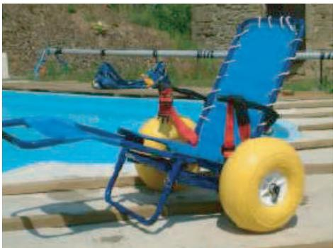
Job, système de roulement sur le sable avec possibilité d'entrer à l'eau sans autonomie pour un handicap de type paraplégie
